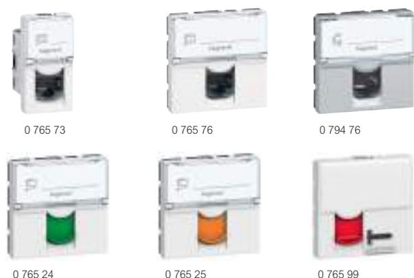
Tomadas RJ 45 com conectores RJ 45 LCS<sup>2</sup> de ligação rápida com acessório de cravação integrado no próprio conector. Aceitam cabos simples com AWG 22- AWG 25 e AWG 26 para cabos multi condutores.
